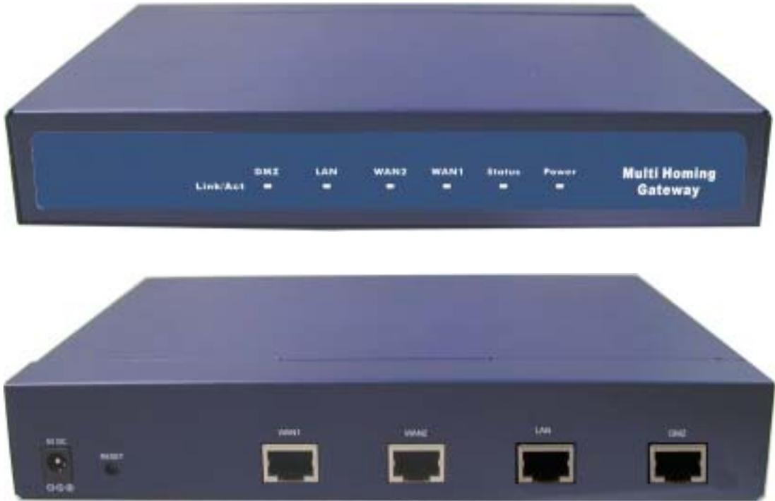
图 H-1 负载均衡器接孔、指示灯说明
