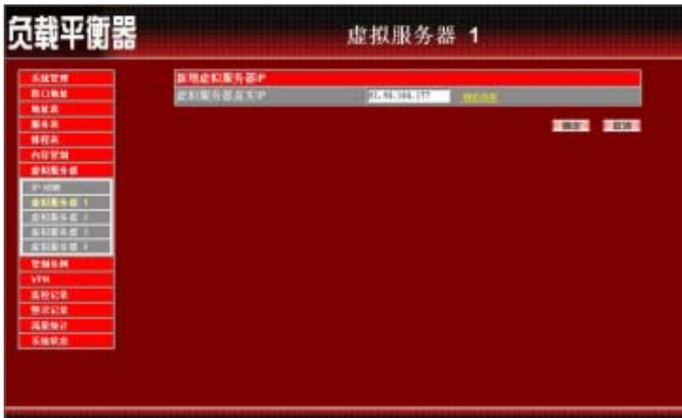
图 7-7 变更虚拟服务器 IP 地址
