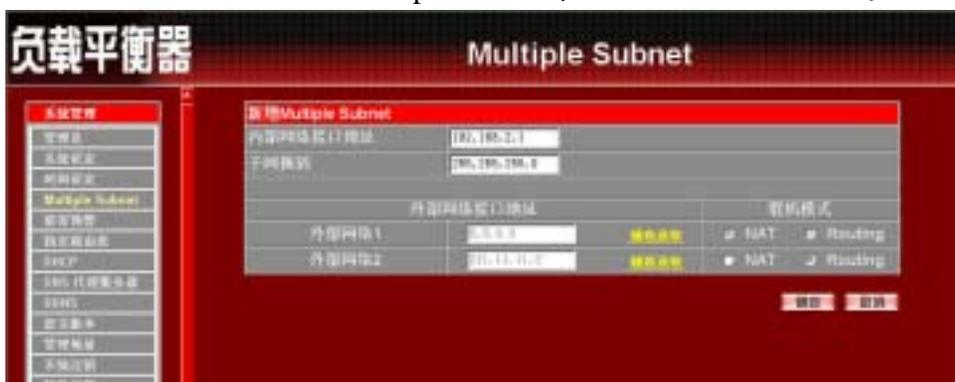
图 1-20 新增 Multiple Subnet Routing 模式
