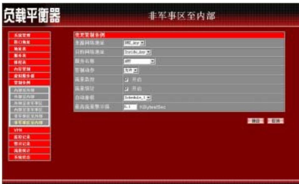
图 8-23 变更非军事区至内部网络管制条例
