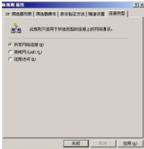
图 9-66 设定连接类型
