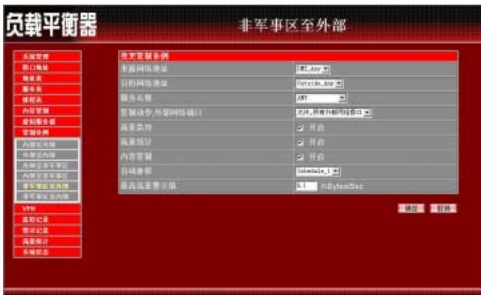
图 8-19 变更非军事区至外部网络管制条例
