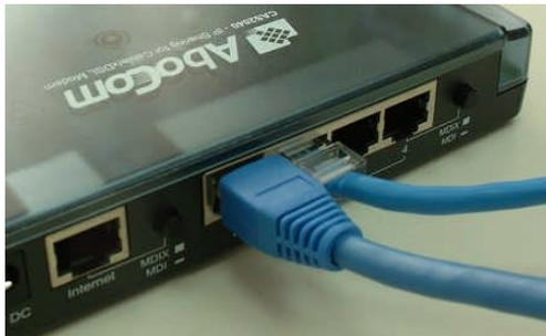
將網路線一端插入電腦上網路卡的(UTP)插孔，另一端插入寬頻分享器的”Local” port 插孔(共可連接 4 部電腦) 如果 Link 燈亮，代表連線正常。
