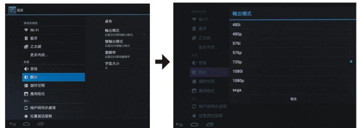
法正常顯示（或顯示全黑螢幕）。這時您必須將電視盒與一台有 Full HD 的電視連接，再調整回 720p 的模式。
